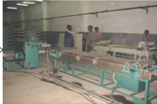
ファイバーの押し出し工程
