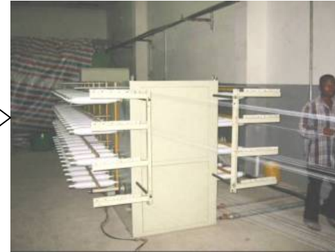
ファイバーのボビンへの巻き取り工程
